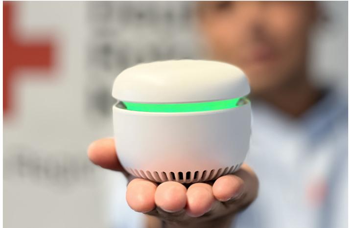
**Grünes Licht für gute Luft: Das neue Gerät im Rotkreuz-Hausnotruf zeigt durch die Farbe des Lichtes die Luftqualität an.**
