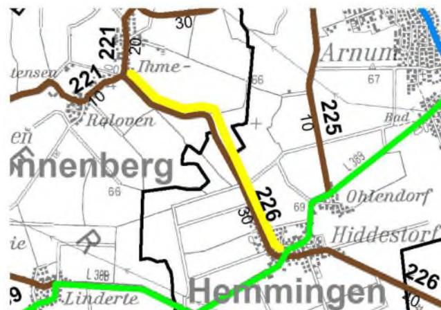
In beiden Ortsdurchfahrten und an der freien Strecke gibt es eine hohe Priorität (1. Dringlichkeit) für die Anlage von Radwegen. Nach erfolgter Fahrbahnsanierung können in beiden Ortsdurchfahrten Schutzstreifen markiert werden und von der freien Strecke ist ein von der Fahrbahn abgesetzter Radweg die geeignete Maßnahme zur Erhöhung der Verkehrssicherheit.
