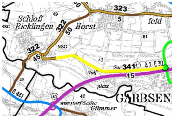
Der rund 4 km lange vorhandene Radweg zwischen Schloß Ricklingen und der L 390 bei Garbsen ist im Vorrangnetz für den Alltagsradverkehr enthalten. Der Radweg befindet sich in einem schlechten Zustand und die Breite entspricht nicht dem aktuellen Stand der Technik, so dass mit der Sanierung der Radweg auf 2,50 m ausgebaut wird.
